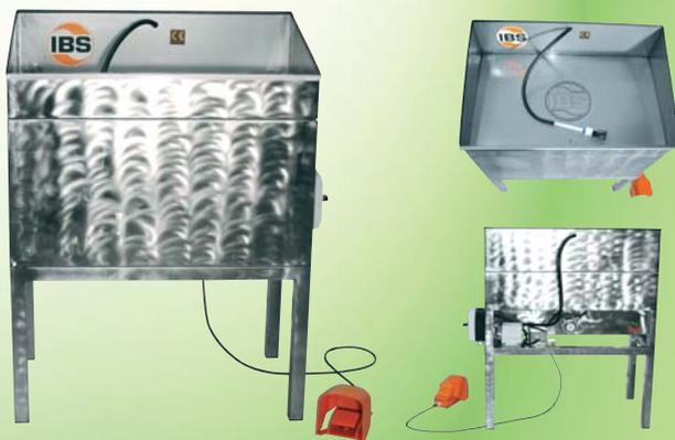
Zum Reinigen von öl- und fettverschmutzten Metallteilen für den Einsatz mit Reinigungsmittel auf wässriger Basis. Es ist wahlweise für Reiniger mit oder ohne Mikroorganismen verwendbar. Die robuste Edelstahlkonstruktion hat einen Badinhalt von 80 l, der auf konstant 40°C gehalten wird.
